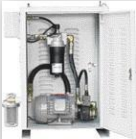
30 Bar mit Doppelfiltersystem
