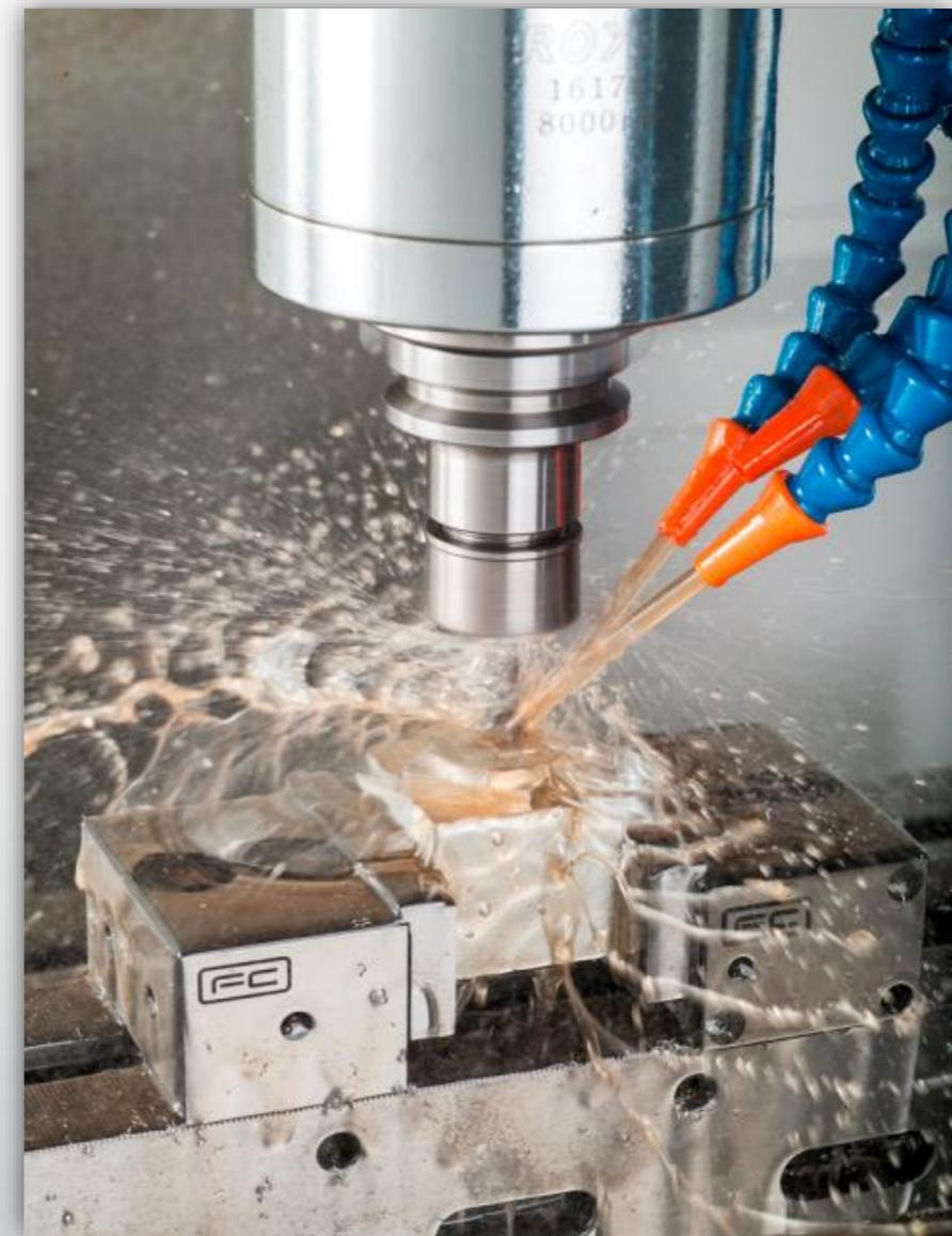
**Ringspülung** an der Spindel und seitlich angebrachte Versorgungsleitung mit **Wasser und Luft** sind Standard
