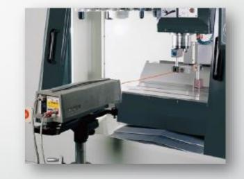
Alle Maschinen können mit direktem Wegmesssystem von Heidenhain ausgerüstet werden.
