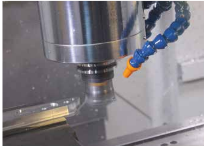
3 Mit der 10-kW-Frässpindel des stabil und gut zugänglich aufgebauten CNC-BAZ PreMill VL 1000 von MMD mit Sinumerik 828D von Siemens lassen sich die Aluminium- oder Stahlkomponenten schnell und präzise zerspanen (© Siemens)
