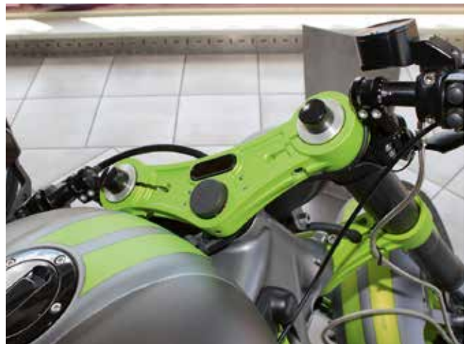
4 Zahlreiche gefräste Zierelemente aus Aluminium (links) geben den Kodlin-Bikes ebenso eine besondere Note wie speziell angepasste Gabelbrücken (rechts) (© Siemens)
